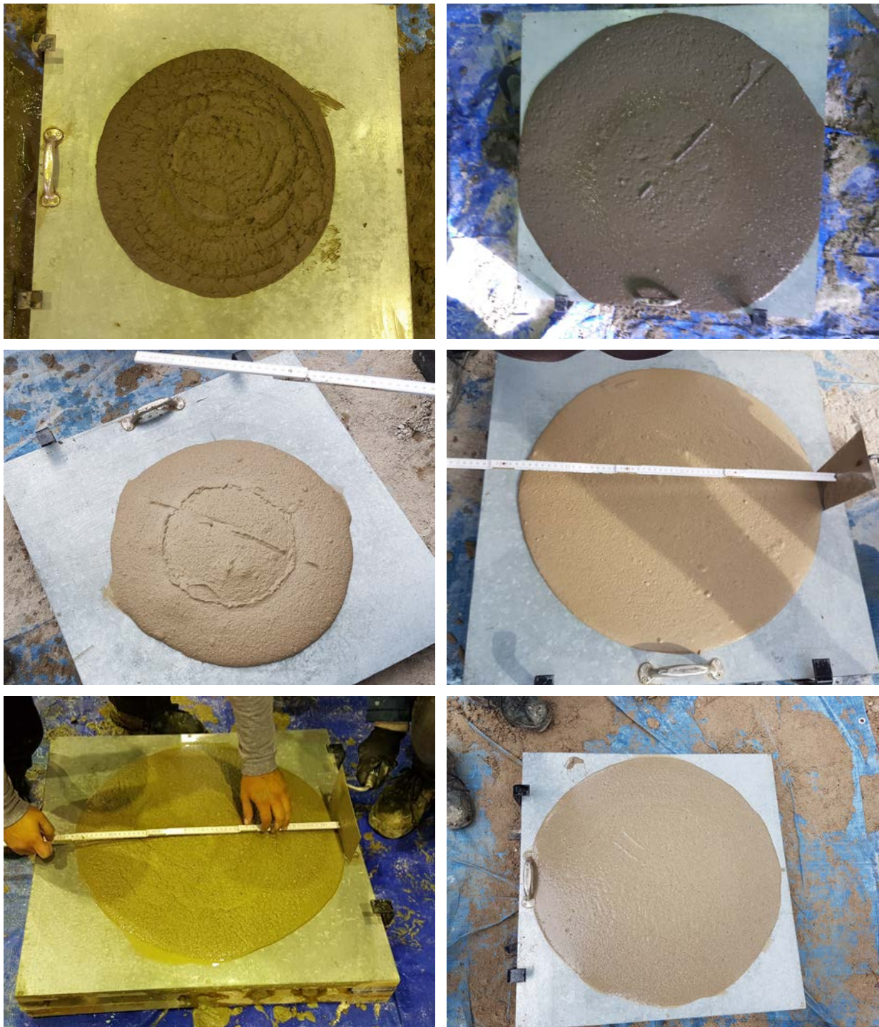
Bild 10 Bewertung des Ausbreitmaßes hinsichtlich der „Lieferbeständigkeit“: F3-Ausbreitmaß (oben links) und F6-Ausbreitmaß (oben rechts) bei „WBM-Flüssigboden®“, F4-Ausbreitmaß (mitte links) und F5-Ausbreitmaß (mitte rechts) bei „carbofill®“, Beispiel für ein Material ohne Auffälligkeiten F5-Ausbreitmaß (unten links) und F6-Ausbreitmaß (unten rechts)
