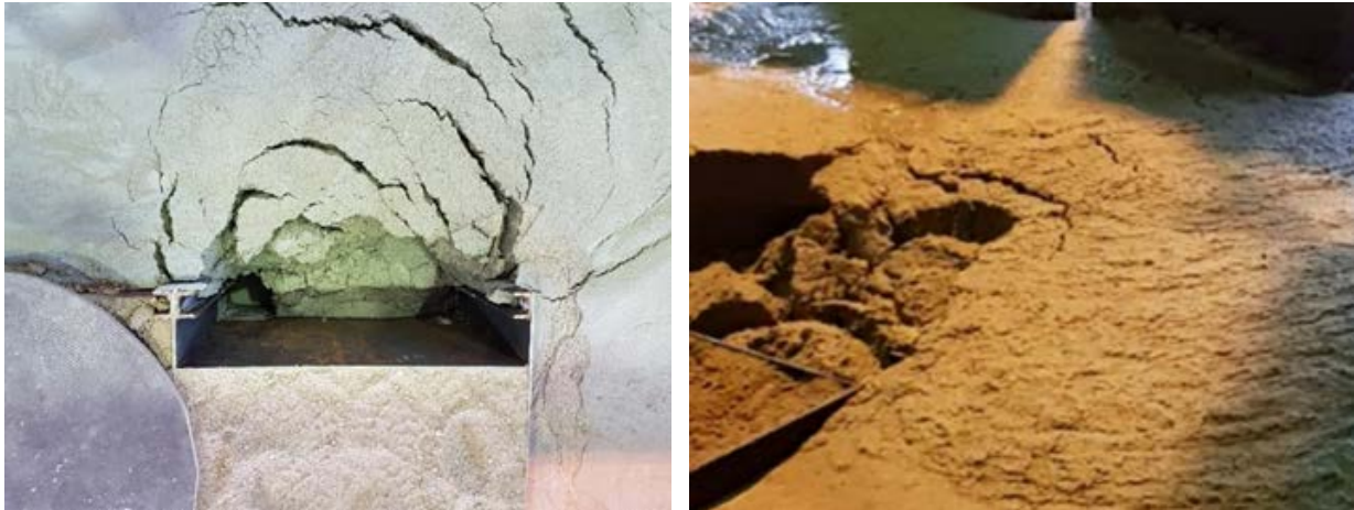
Bild 16 Oberflächenbruch „Terrapact“ (links) und „RSS® Flüssigboden“ (rechts)
