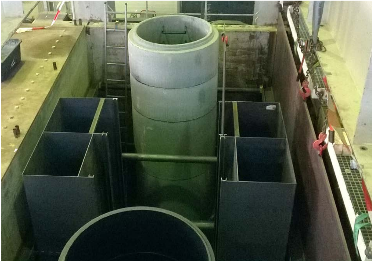
Bild 4 Einbauten in einer Versuchskammer vor dem Einbau des Flüssigbodens (ZFSV) mit Betonschacht (hinten), Kunststoffschacht (vorne) und Verbaukästen (seitlich)
