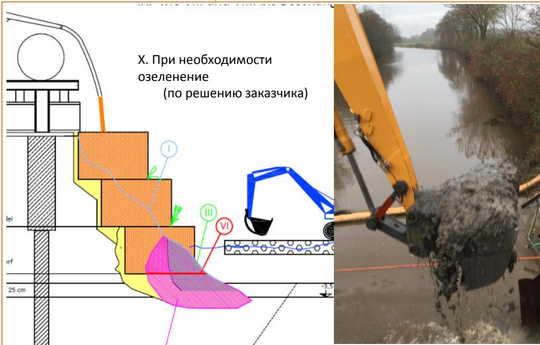
**Стабилизация откосов:** постоянные укрепления берегов при проточных водах с целью устранения вымоин, повышения устойчивости откосов и укреплений берегов, а также предотвращения образования новых вымоин, с многочисленными другими возможностями улучшения укрепления берегов и защиты от наводнений за счет дополнительного использования геотекстиля, включая все необходимые испытания; методы расчета и выполнение проверочного расчета.
